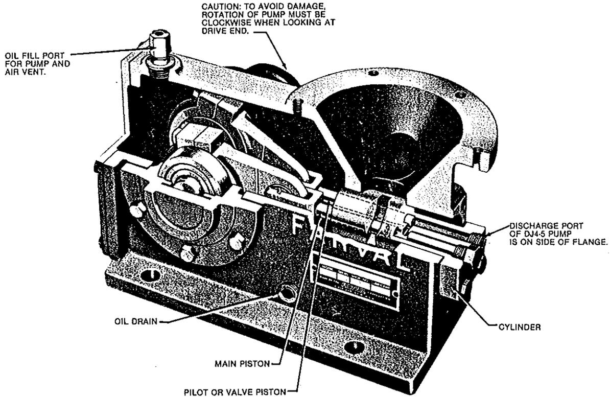
CUTAWAY VIEW OF PUMP.
