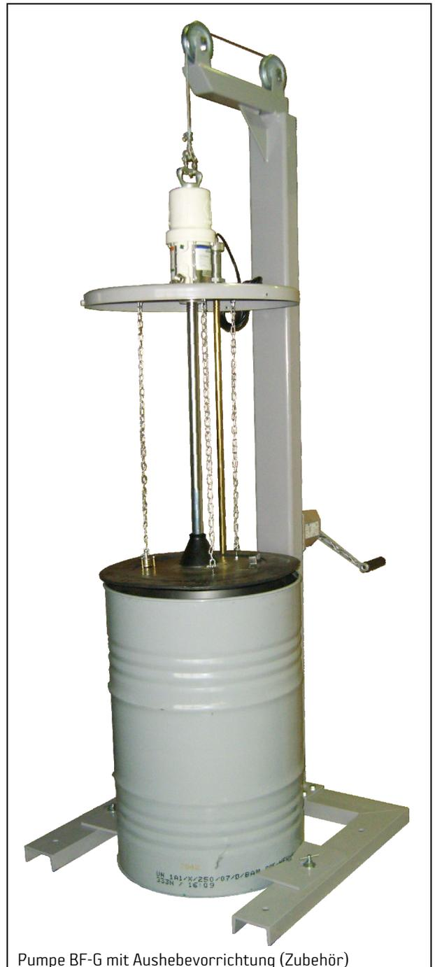
Pumpe BF-G mit Aushebevorrichtung (Zubehör)
