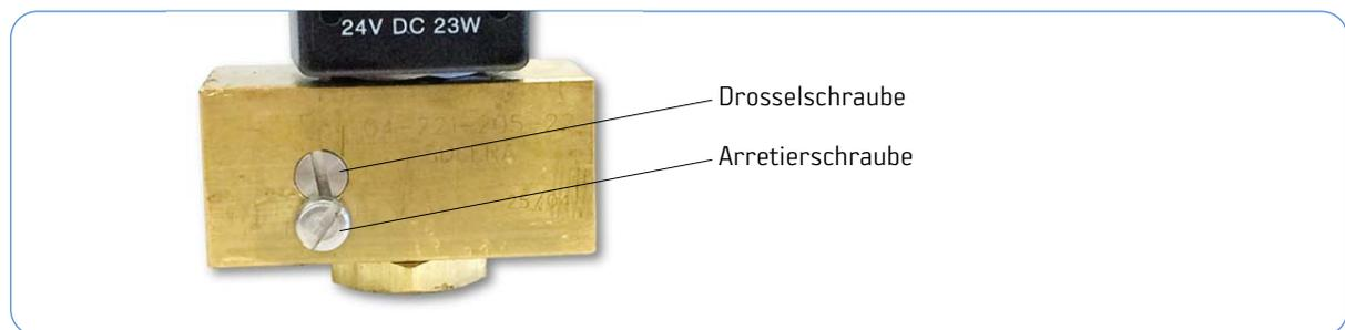
Soweit nicht alle Verteiler beim ersten Mal gearbeitet haben (keine Funktion sichtbar), ist der Vorgang zu wiederholen, indem die Drosselschraube wieder vollständig nach links bis gegen die Arretierschraube zurückgedreht wird und dann langsam wieder nach rechts geschlossen wird. Die Verteiler werden nicht gleichzeitig anspringen, meistens zeitlich versetzt.
