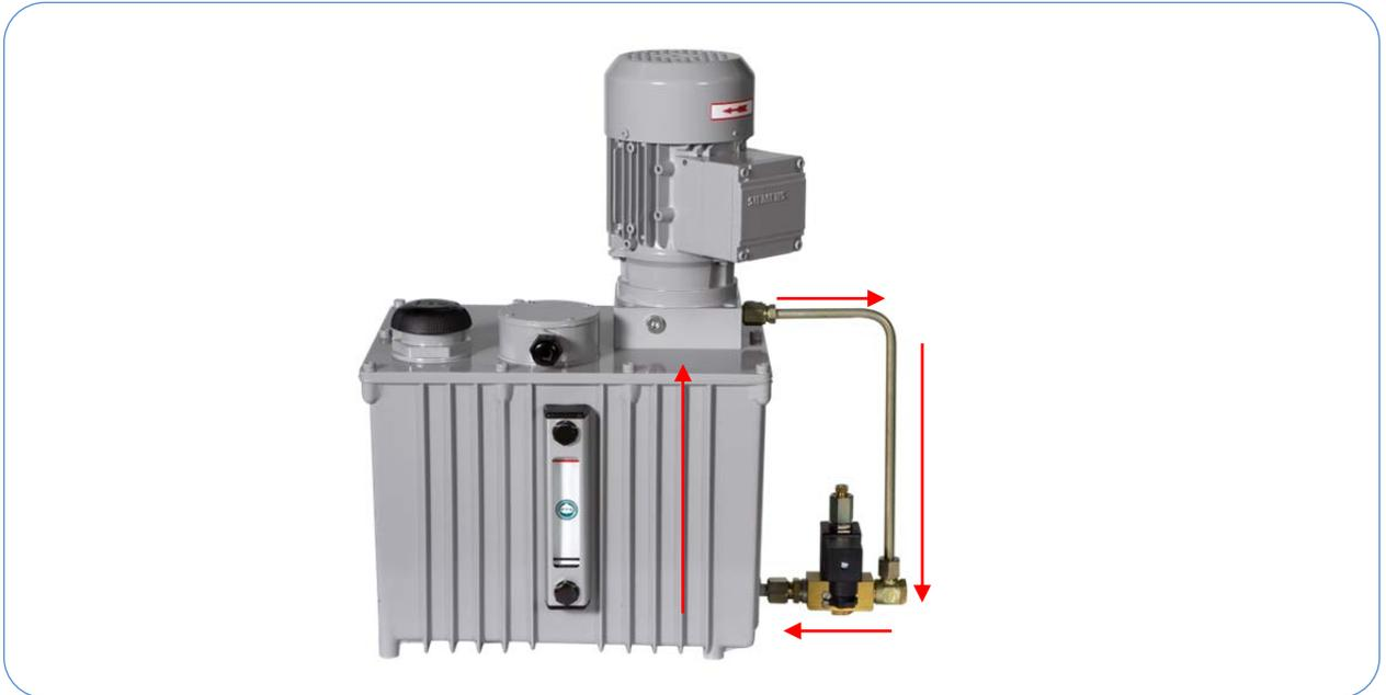
Mit Starten der Stromzufuhr zum Magnetventil wird dieses mechanisch umgeschaltet, der Öl-Kreislauf wird unterbrochen. Das Öl wird schlagartig Richtung Auslass gefördert und kann, falls das Aggregat im System WS-E eingesetzt wird, die nachfolgenden Verteiler ZE-E bedienen. Diese geben dann ihre vorgespeicherte Schmierstoffmenge mit hoher Geschwindigkeit über die Spritzdüsen (in Form eines gezielten Tropfens) an die Schmierstellen ab.
