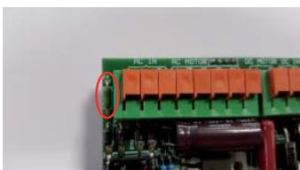
GLEICHSTROMPUMPEN – „F1“
